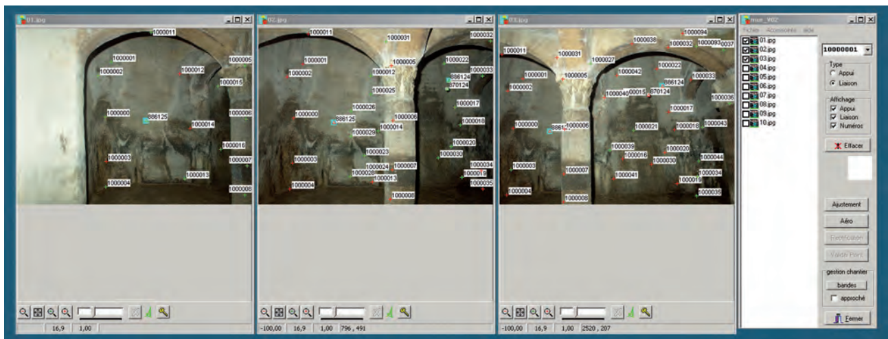
Fig. 8. Nuages de points de la couverture et de la travée centrale de la citerne. Redressement des photographies à l'aide du logiciel Redresseur. L. Borel © CEALex, Y. Egels © IGN.
