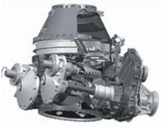
**Fig. 1.** Boîte de transmission principale d'hélicoptère vue en 3D.
