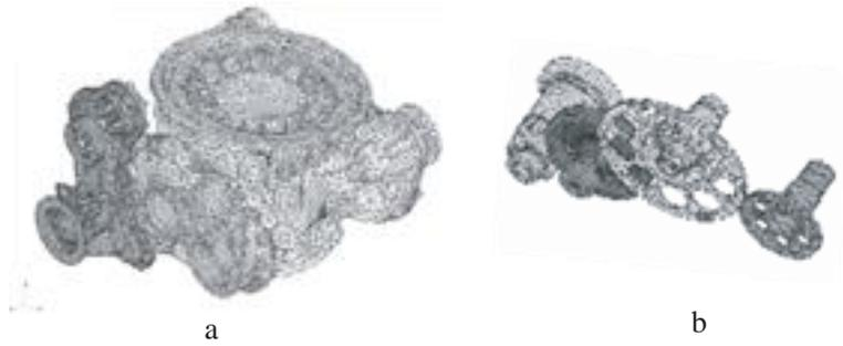
**Fig. 9.** Maillage du carter d'une transmission d'hélicoptère ; (b) maillage d'une partie des pièces à l'intérieur du carter.
