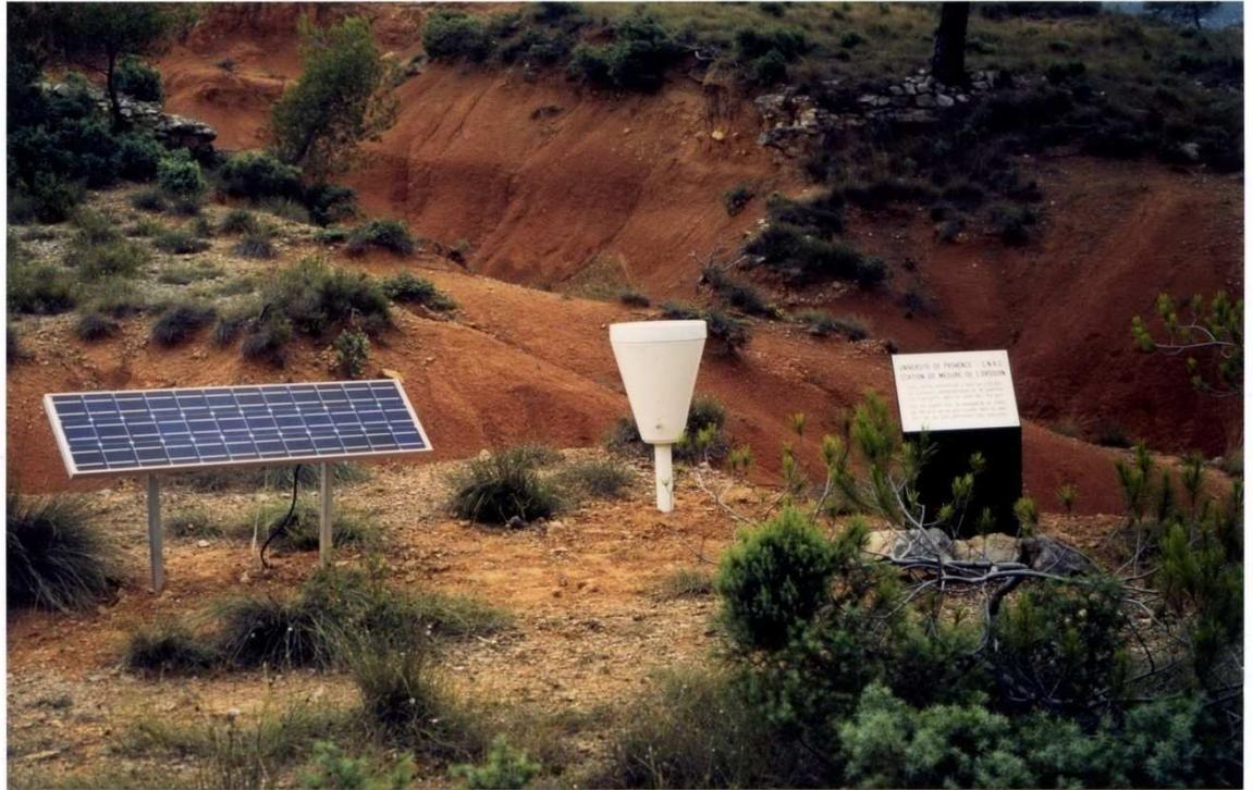
Photo 2 : Le pluviographe, le panneau solaire et le panneau de présentation de la station.
