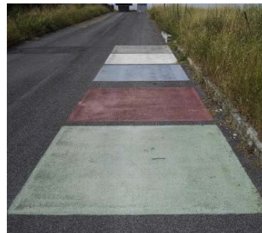
Figure 12. Etudes de l'impact de l'albédo des revêtements de sol (Carnielo et Zinzi, 2013)
