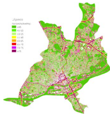
Figure 29. Carte de bruit de la ville de Nantes, obtenue avec le modèle NMPB2008 et avec le logiciel open source « NoiseModelling »
