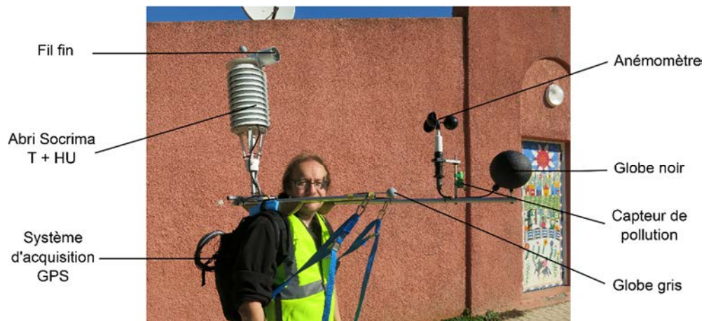
Figure 3. Station mobile développée par le CNRM/GAME pour caractériser les conditions de confort thermique
