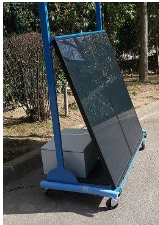
Figure 4 : Station mobile photovoltaïque équipée de deux panneaux CIS de 80Wc. Les panneaux sont de la marque Würth Solar™ dont la référence est WSG0036E080.
