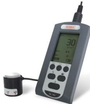
Figure 8 : Solarimètre SL100 (Kimo®, coût 430 \text{ € TTC} ). Bande spectrale de 400 \text{ nm} à 1100 \text{ nm} , avec une gamme d'irradiance de mesure de 1 \text{ W/m}^2 à 1300 \text{ W/m}^2 . La cellule de détection est constituée de silicium polycristallin, conformément au spectre d'absorption représenté sur la Fig. 2. Il existe également des pyranomètres (synonymes de solarimètres), par exemple le PYR1307 (coût 130 \text{ €} ), mais sa bande spectrale d'absorption va de 300 \text{ nm} à 1000 \text{ nm} .
