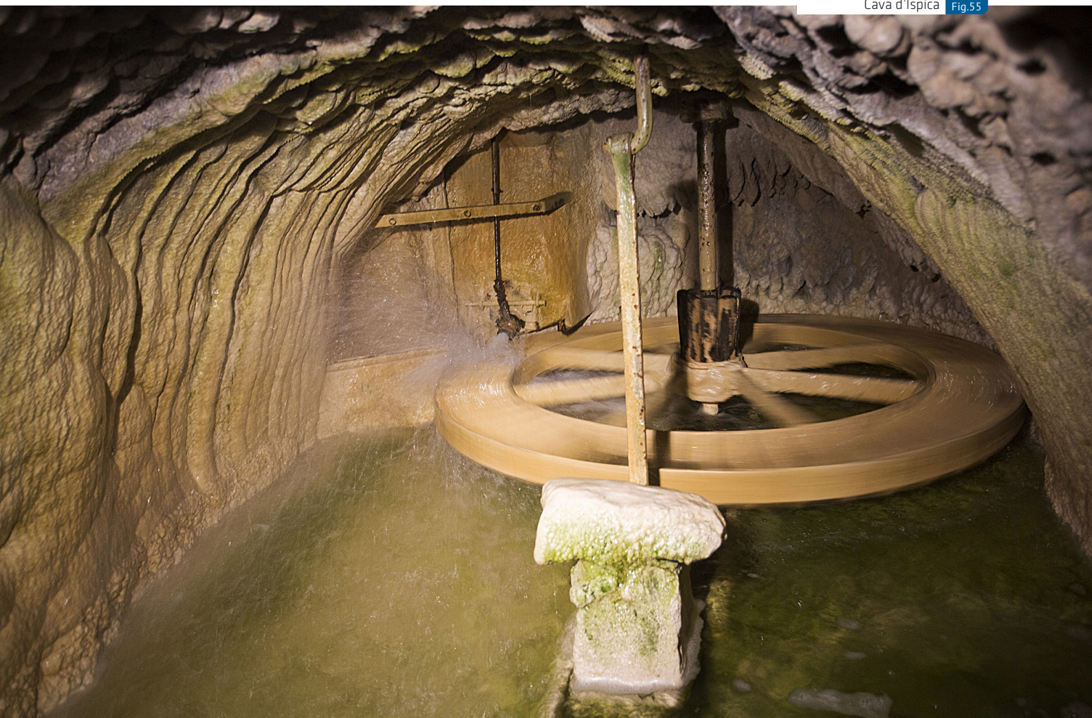
Exemple de roue horizontale, moulin du XVIII e siècle, Cava d'Ispica
