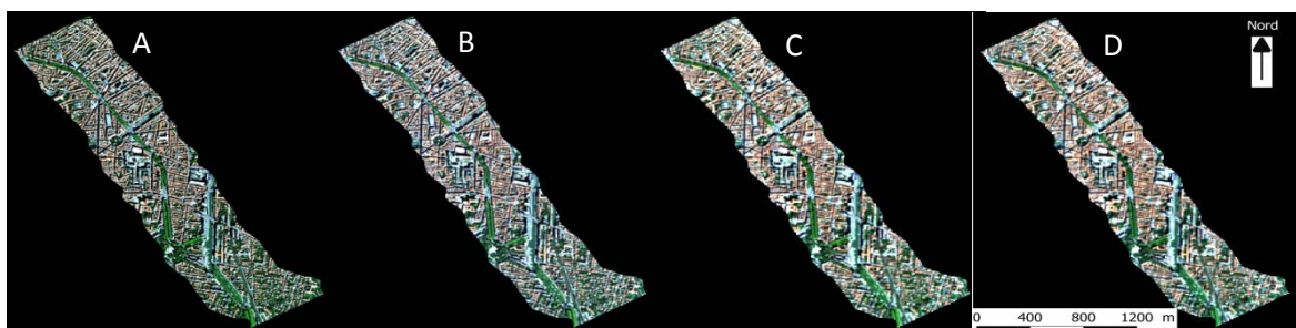
Figure 36 - Composition colorée vraies couleurs des images HS et Sentinel 2. A : Image HySpex à 2m de résolution spatiale ; B : image Hypxim à 4m ; C : image Hypxim à 8m ; D : image Sentinel 2
