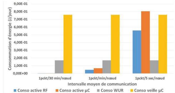
Figure 3- Consommation d'énergie par jour d'un réseau de capteurs de 20 nœuds en fonction du niveau de trafic
