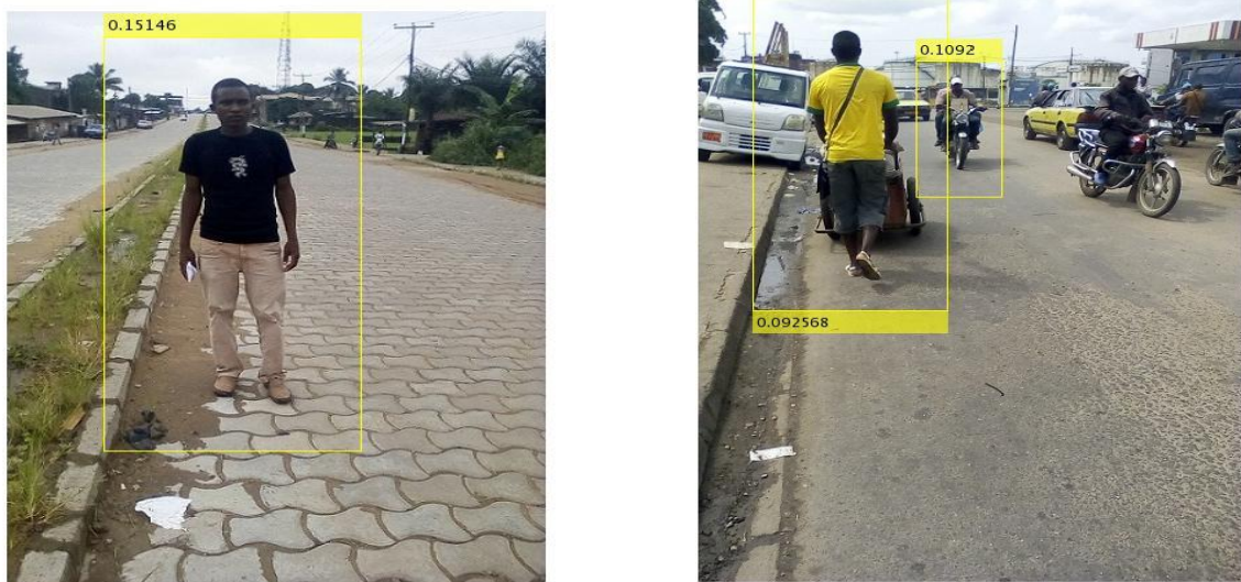
Figure 5.1 : Simulation de l'identification d'un piéton dans le cas d'un piéton longeant la route
