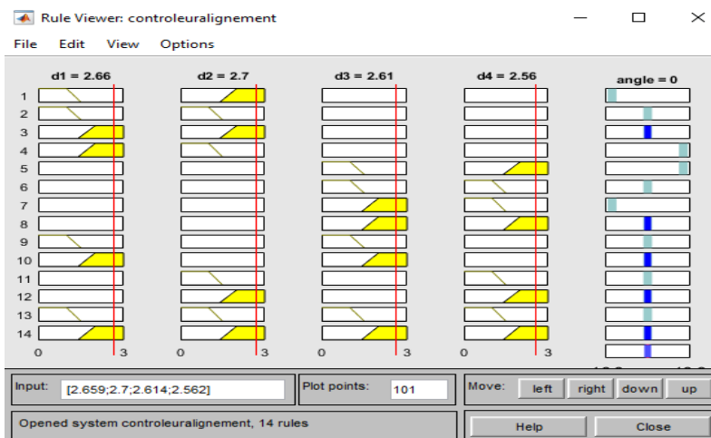
Figure 5.12 : Illustration de l'inférence des valeurs de commande du contrôleur flou d'évitement
