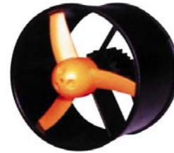
Figure 2. Propulseur GWS™ de type EDF50 équipé d'un micromoteur à courant continu de référence CN12-RXC. Ce propulseur est capable de développer une poussée de 72 g sous 7,2 V.
