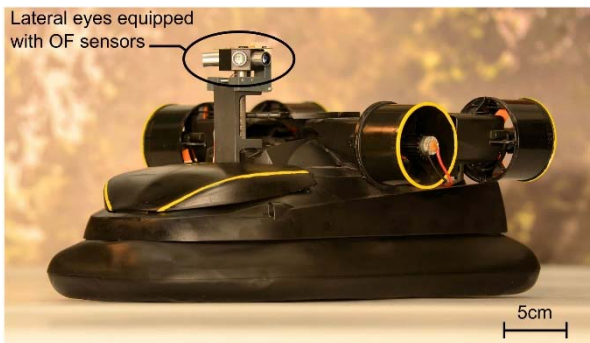
Figure 1. Robot LORA (taille : 0,36x0,21x0,17 m, masse : 878 g). Le robot est équipé de deux packs d'accumulateurs lithium polymère distincts : un pack faible puissance 7,2 V - 360 mAh ; taille 54x31x7 mm ; masse 20 g pour l'électronique, et un pack de forte puissance 7,2 V - 2200 mAh ; 21x33x96 mm, masse 112 g pour la propulsion procurant au robot une autonomie de 10 minutes [10,11]. Le robot est équipé de petits yeux relié à des capteurs de mouvement bio-inspirés, une partie du traitement de l'information visuelle pour extraire l'information de mouvement, appelé flux optique, est abordée dans les deux autres mini-projets.
