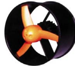
Figure 2. Propulseur GWS™ de type EDF50 équipé d'un micromoteur à courant continu de référence CN12-RXC. Ce propulseur est capable de développer une poussée de 72 g sous 7,2 V.
