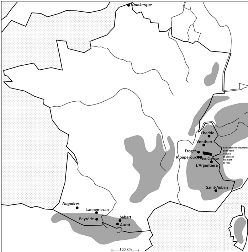
Fig. 1 : Implantation des usines de production d'aluminium en France depuis 1889 (carte du relief). Les usines sur la carte, mises en fonction entre 1889 et 1939, sont implantées en montagne à proximité de sources d'énergie (hydroélectrique), à l'exception des usines de Noguères et de Dunkerque ( italique ), démarrées plus tard, respectivement en 1960 et 1991 et construites selon une autre logique d'approvisionnement en énergie (gaz et nucléaire). Source : René Lesclous, op. cit. © M. C.
