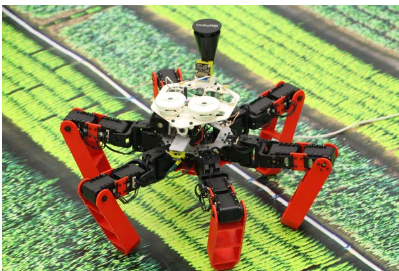
Figure 1. Le robot hexapode AntBot inspiré de la fourmi du désert Cataglyphis. Copyright : Julien Dupeyroux.
