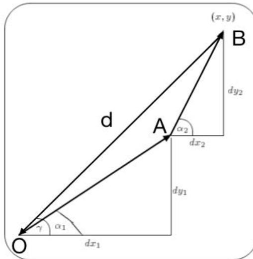
Figure 4. Illustration de la stratégie de navigation à l'estime. Trajectoire d'exploration composée de 3 points : O,A,B. En partant du point O vers la direction A puis B, il est possible de revenir au point O depuis le point B en suivant le cap estimé  $\gamma$  et les distance au point de retour notée  $d$ . Pour revenir au point O, il faut mesurer les caps notés  $\alpha_1$  et  $\alpha_2$  ainsi que la vitesse de déplacement entre chaque point. (Adapté de Nehmzow 1993).
