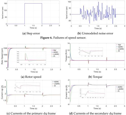
c) Currents of the primary dq frame (d) Currents of the secondary dq frame Figure 7. PMSM performance in the first faulty mode.
