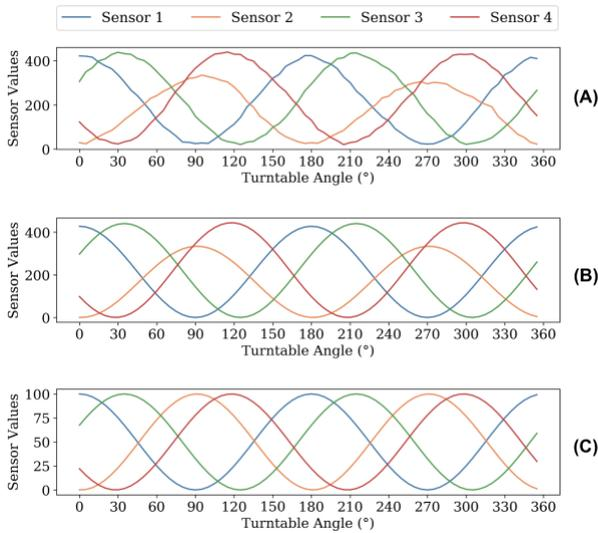
**Figure 8.** Exemple de calibration des photocapteurs de la méthode orthogonale (cf. Fig. 7A). (A) Données brutes. (B) Valeurs des capteurs après ajustement de la courbe (moindres carrés) ; (C) Valeurs des capteurs après normalisation du gain. Valeur de sortie en unité arbitraire.
