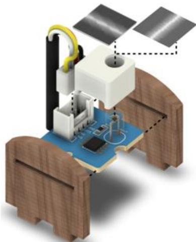
**Figure 6.** Photocapteur individuel composé d'un module Grove Light (photorésistance sur carte électronique), de 2 supports en bois, d'un support en plastique blanc servant d'isolant optique et de support pour le filtre polarisant posé au-dessus de la photorésistance. Les filtres sont découpés et collés. (D'après le rapport des étudiants N. Thellier et N. Thouvenel)
