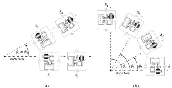
**Figure 7.** Représentation schématique des photocapteurs pour illustrer la configuration orthogonale (A) et circulaire (B). Chaque photocapteur dispose ici d'un filtre polarisant représenté par un cercle barré.
