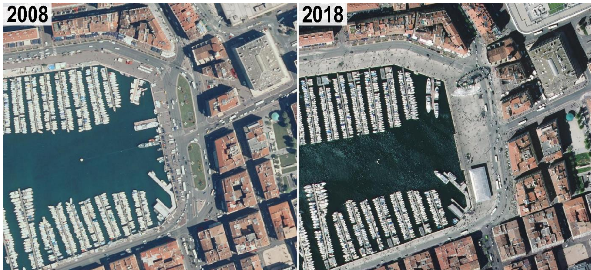
Figure 5 : Les quais du Vieux-Port avant et après leur réaménagement (source : Géoportail ; IGN - remonter le temps). Le nombre de voies ouvertes à la circulation est drastiquement réduit, parallèlement à l'instauration d'une zone 30. Le quai des Belges passe de 9 voies à 4 voies (une voie dans chaque sens pour les véhicules et deux voies réservées aux bus). C'est au niveau de ce quai, renommé Quai de la Fraternité, que l'emprise gagnée pour le piéton est la plus conséquente, permettant de réaliser une grande place piétonne agrémentée d'une ombrière conçue par l'architecte Norman Foster.
