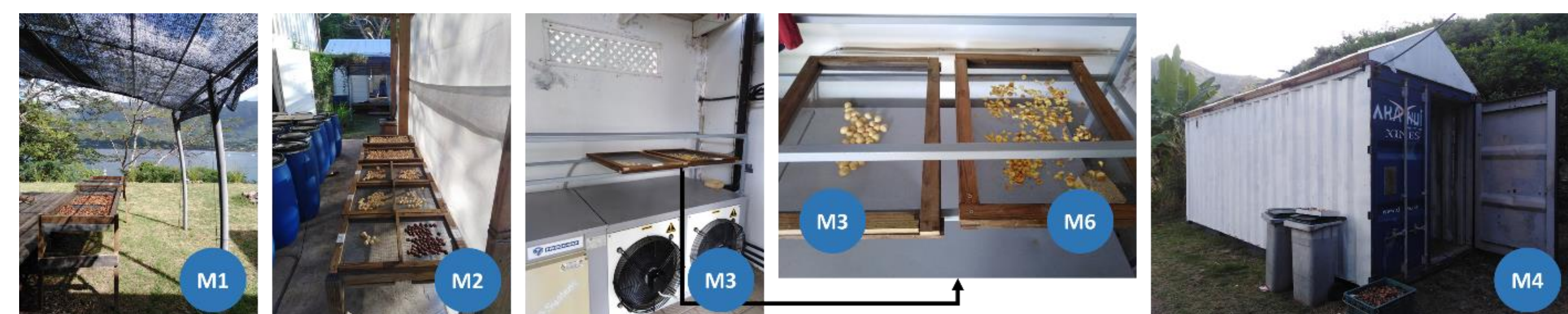
6 méthodes de séchage différentes testées à Taiohae, Nuku Hiva (septembre 2020) : M1 : en extérieur ; M2 : en extérieur couvert ; M3 : sous ventilation (air chaud) ; M4 : en conteneur ventilé ; M5 : en conteneur fermé (non ventilé) ; M6 : identique à M3 mais avec des amandes coupées. M2-2 : identique à M2 mais récolte en janvier 2020 (graines sèches).
