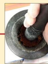
Extraction à l'échelle du laboratoire : Broyage de 15 ± 2 g d'amandes sèches, macération avec de l'acétate d'éthyle (EtOAc), sonication et concentration de l'extrait.
