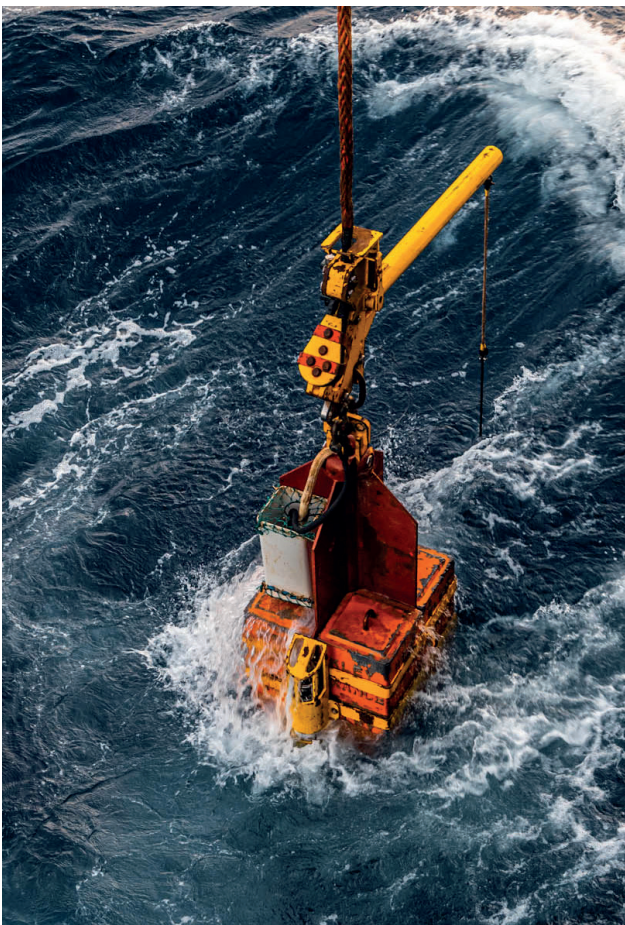
B 3.2.1.3 – Mise à l'eau du carottier CALYPSO, Campagne Amaryllis, N/O Marion Dufresne. © A. Duhayon
