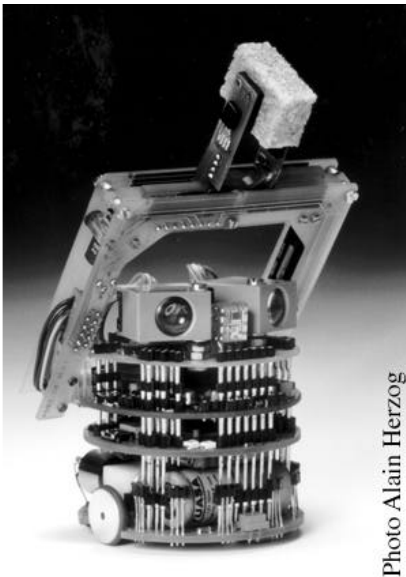
Fig. 1 Le robot miniature Khepera, avec module de vision et pinces
