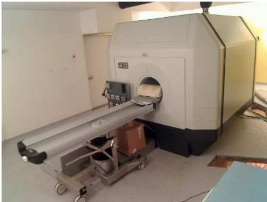
Figure 9 : imageur Bruker 3-T MEDSPEC 30 / 80 AVANCE du Centre d'IRM fonctionnelle (INT, UMR 7289, CNRS - Aix Marseille Université).
