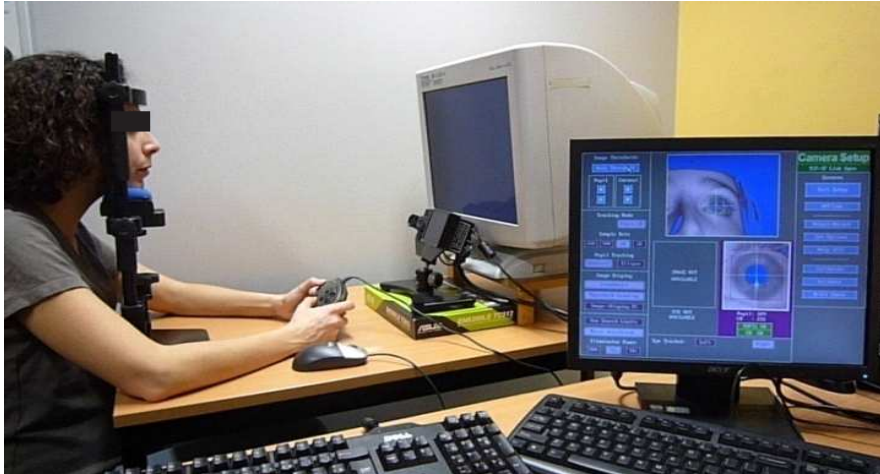
Figure A.30 : Dispositif expérimental utilisé pour l'oculométrie.
