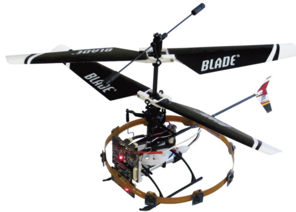
FIGURE 1.10: Micro-hélicoptère de 30 g utilisant un capteur visuel omnidirectionnel de 2,6 g en forme d'anneau fonctionnant à 10 Hz. Celui-ci est composé de 8 caméras configurées pour délivrer des images de 16 x 16 pixels. Un total de 2048 pixels sont répartis sur un champ de vision de 360 x 60 degrés afin d'y calculer le flux optique. Tirée de [Moore et al., 2014].
