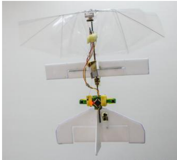
FIGURE 1.12: Drone à ailes battantes Delfly explorer de 20 g capable de décoller et de naviguer de manière autonome en évitement des obstacles pendant 9 minutes. Tirée de [Fonville, 2016].
