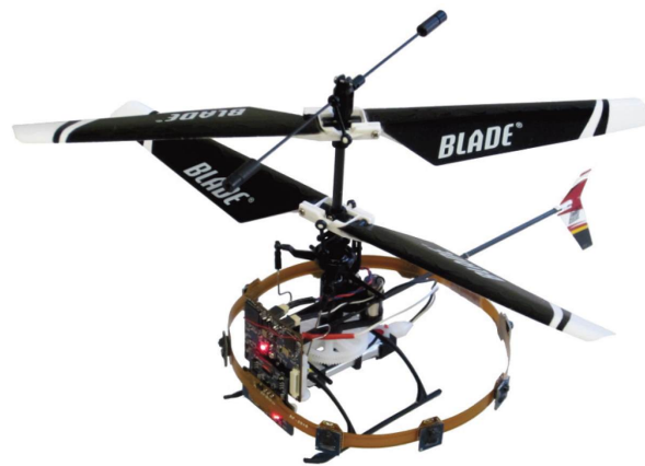
FIGURE 1.10: Micro-hélicoptère de 30 g utilisant un capteur visuel omnidirectionnel de 2,6 g en forme d'anneau fonctionnant à 10 Hz. Celui-ci est composé de 8 caméras configurées pour délivrer des images de 16 x 16 pixels. Un total de 2048 pixels sont répartis sur un champ de vision de 360 x 60 degrés afin d'y calculer le flux optique. Tirée de [Moore et al., 2014].
