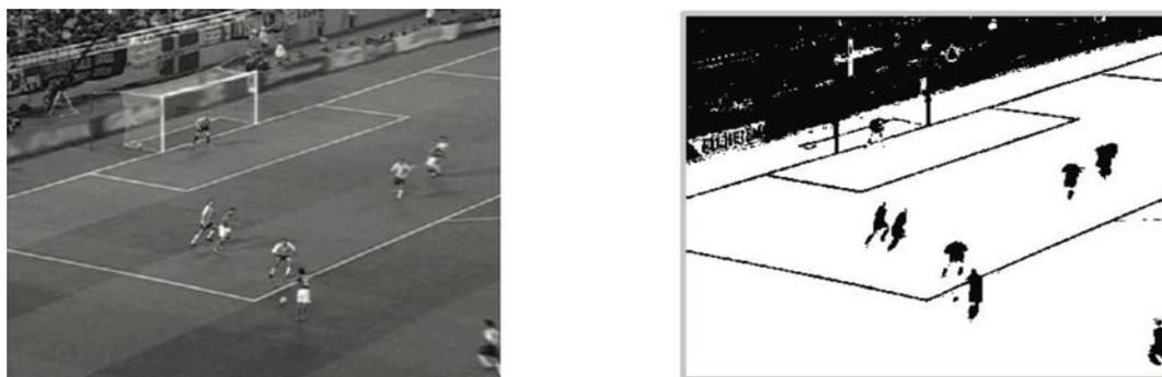
**Figure 1.5.** A droite, en blanc, les pixels retenus par l'analyse colorimétrique
