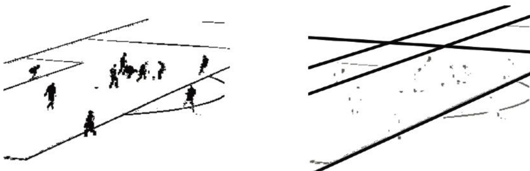
Figure 1.7. A gauche, les résultats de l'analyse colorimétrique. A droite, la détection des droites après suppression des joueurs
