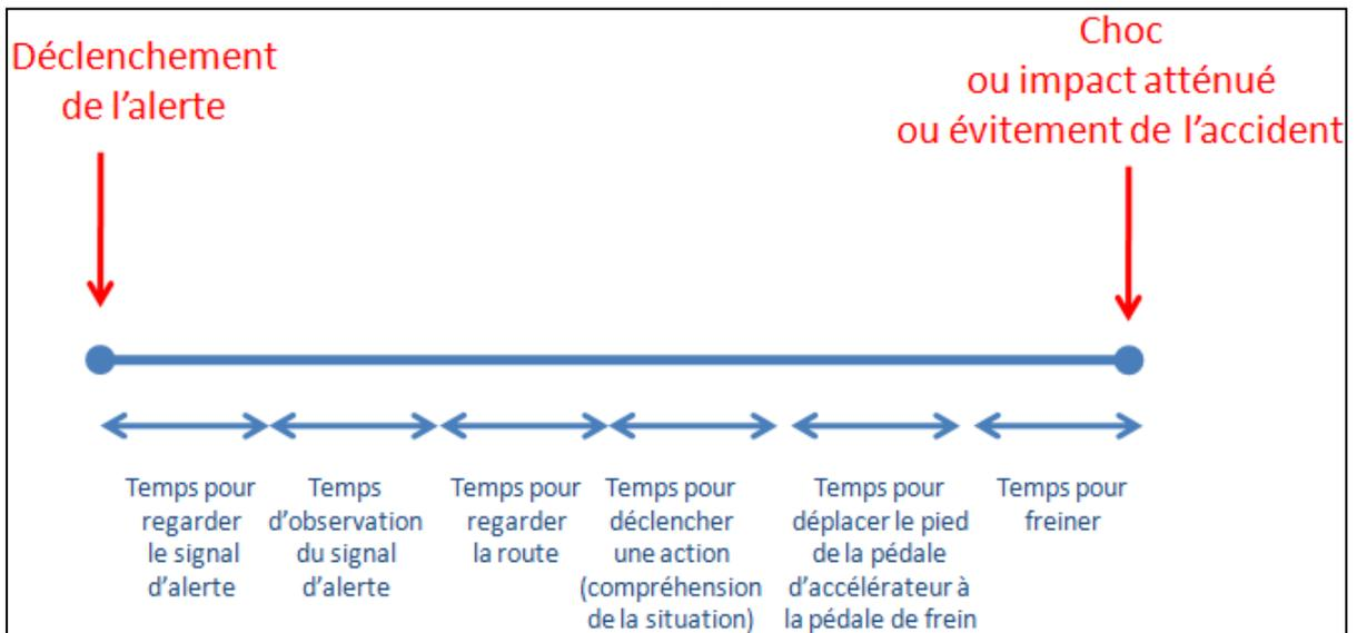
Figure 6: Différentes phases de la réaction du conducteur
