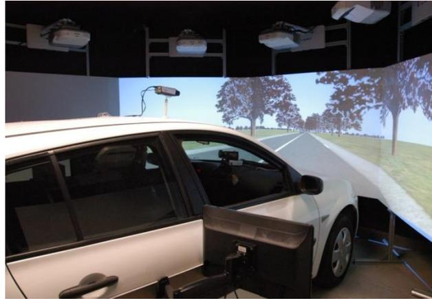
Figure 1: Simulateur de conduite utilisé pour l'expérimentation.
