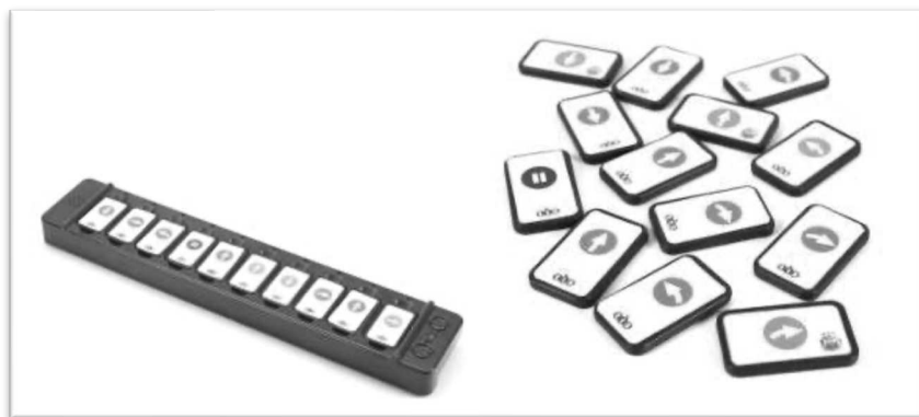
Figure 8 : Barre de programmation et cartes commandes Blue-Bot
