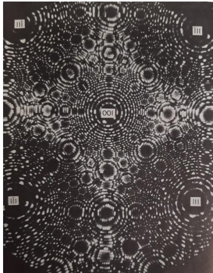
Figure 12: Image des positions atomiques d'une pointe d'iridium vue par FIM, à 10^{-3} Torr de pression d'hélium (extrait de Müller 23 ).
